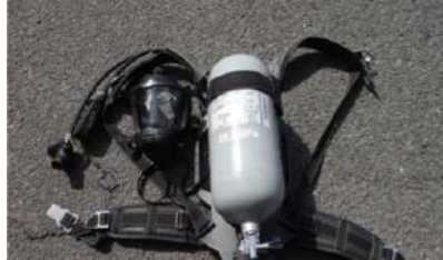
空気呼吸器 ボンベの中に空気が充填しており、煙の中でも呼吸ができます。
