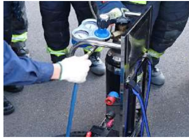
酸素溶断機 酸素の力を使い鉄等を溶断します。水中でも使用できます。
