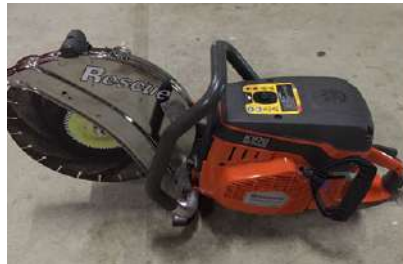
エンジンカッター エンジンの力を利用して、鉄板等を切断します。
