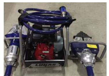
油圧式救助器具 油圧の力で物を切断したり広げたりします。
