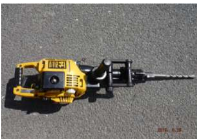
削岩機 硬い岩盤、コンクリートなどを削岩します。
