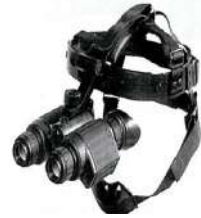
ナイトビジョンゴーグルボンベ 光量子を電子に変換し、暗い場所でも物が見えるようになります。
