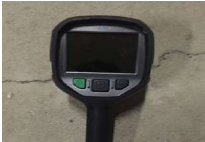
赤外線カメラ (フレア) 濃煙・暗夜での表面に出ない熱を感知します。
