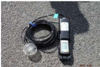
ガス検知器 酸素、可燃性ガス、硫化水素、一酸化炭素を検知、測定します。
