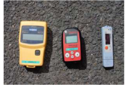
放射線測定器 X線、γ線、β線を検知または測定します。
